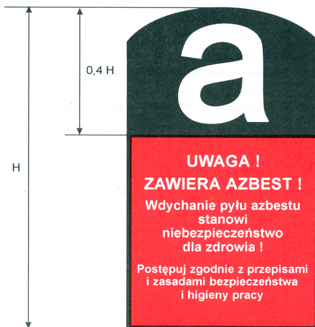
Rys.4.1. Wzór etykiety do oznakowania wyrobów i odpadów zawierających azbest, zgodnie z załącznikiem do Rozporządzenia Ministra Gospodarki, Pracy i Polityki Społecznej z dnia 2 kwietnia 2004 r. w sprawie sposobów i warunków bezpiecznego użytkowania i usuwania wyrobów zawierających azbest.
