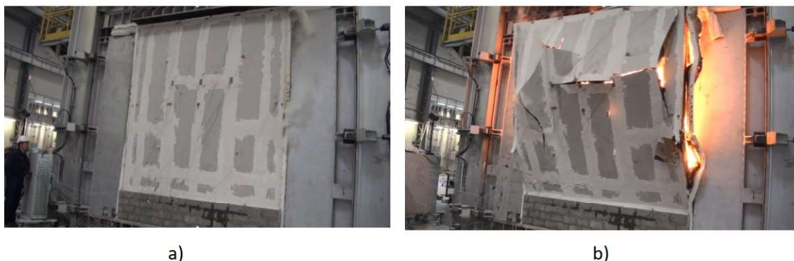
Fot. 6.6. Widok ściany nośnej o drewnianym szkielecie z okładzinami gipsowo-kartonowymi: a) w trakcie badania, b) po przekroczeniu 60 minut, w trakcie zniszczenia (fot. Z archiwum ITB)
