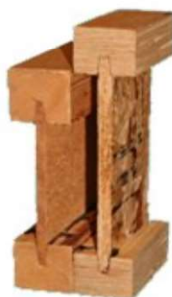
Fot. 2.13 Po lewej stronie belka dwuteowa z pasami z drewna litego i środnikiem z płyty pilśniowej, po prawej – z pasami z LVL i środnikiem z płyty PSB. (fot. E.I. Kotwica)
