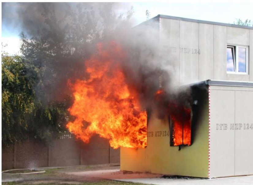
Fot. 1.14 Zasięg płomieni z pomieszczenia, w którym znajduje się źródło ognia. (fot. E.I. Kotwica)
